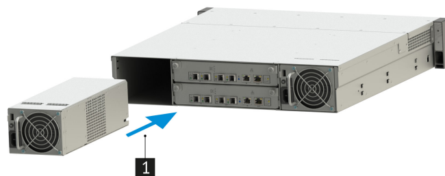
Рис. 48. Установка блока питания.
