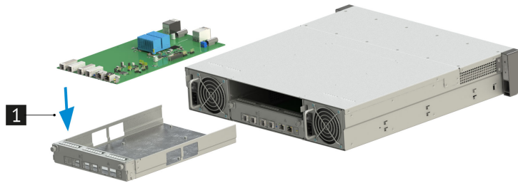
Рис. 32. Установка платы SAS-экспандера
